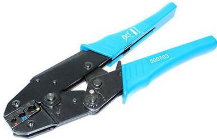
Um die Kabelschuhe/Iso-Klemmverbinder vernünftig auf euer Kabel anzubringen, solltet Ihr auch ein so eine Crimpzange für Quetschverbinder in eurem Werkzeugsortiment haben.
