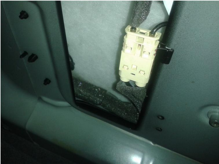
Wenn Ihr in den Kofferraum hineinschaut, findet Ihr oben links in der Öffnung im Deckenblech diesen Stecker, der mit einem Fixierungsclip an der Karosserie klemmt.
