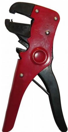
Wer zu faul ist die wenigen Kabel für die ISO-Quetschverbinder / Kabelschuhe mit einem scharfen Messer o.ä. abzuisolieren, kann auch zu so einer Abisolierzange greifen.
